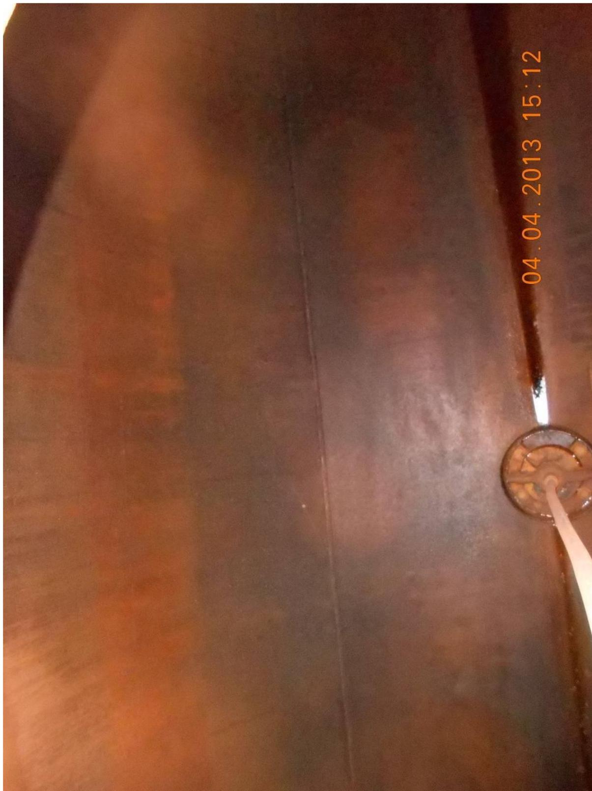
Рисунок 28 – Ржавый металл внутренних стенок цистерны после промывочно-пропарочного способа обработки цистерны
